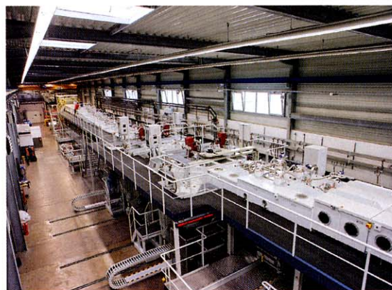
Vakuummaschine zur Beschichtung von Metallbändern (Foto: ALANOD Aluminium-Veredelungs GmbH & Co. KG)
